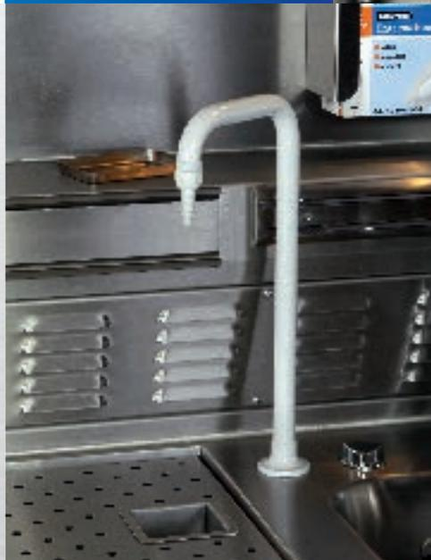
Formalinausguss mit herausnehmbarem Feinsieb. Formalinversorgung mit Labor-Standardarmatur
