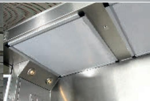
Zuluft durch laminarartige Verdrängungströmung von oben auf die Arbeitsfläche als Zubehör möglich
