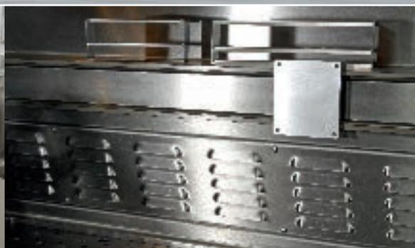
Flächenabsaugung mit zusätzlicher Rückwandabsaugung. Kamerastativschlitten zur Aufnahme eines Stivaufsatzes
