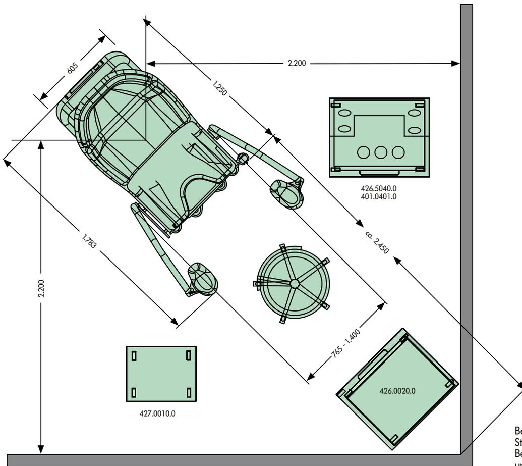
Beim Bodenanschluss muss das Kabel im Bereich der Stellfläche (1.135 x 605 mm) liegen. Innerhalb dieses Bereiches kann der Gyn-Stuhl entsprechend verschoben und gestellt werden.
