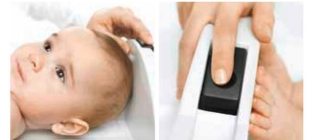
Die Arretierung des Fußanschlags ermöglicht das Ablesen der Werte auch nach dem Messen.
