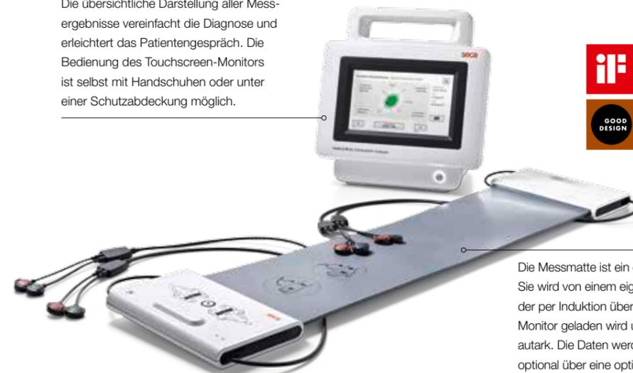
Die Messmatte ist ein echtes Multitool. Sie wird von einem eigenen Akku gespeist, der per Induktion über den Touchscreen-Monitor geladen wird und arbeitet völlig autark. Die Daten werden per WLAN oder optional über eine optische Schnittstelle an den Monitor übertragen.
