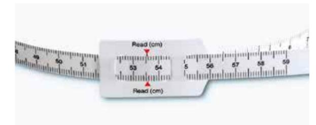
Mit der gut sichtbaren, roten Markierung kann das Ergebnis leicht und präzise abgelesen werden.
