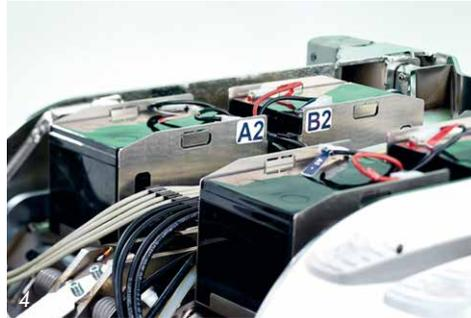
4 Insgesamt **vier Akkus** im Operationstisch, aufgeteilt in zwei voneinander unabhängige Akkumodule, liefern Energie für gut **100 Operationen**. Zwei Energiequellen sichern somit die Betriebsbereitschaft des Tisches und gewährleisten eine netzunabhängige, elektrohydraulische Verstellung jeder Tischfunktion.
