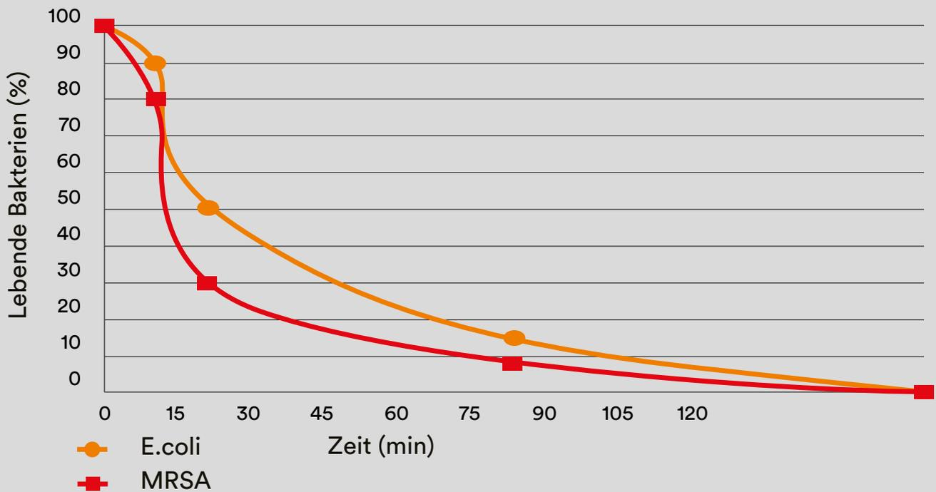
Die antimikrobielle Silberionen-Technologie reduziert die Vermehrung von Mikroben um bis zu 99 % in den ersten zwei Stunden.
